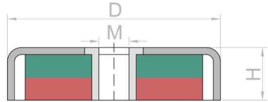
Fuerza transversal: la fuerza de sujeción indicada se midió en perpendicular a la base de adherencia. Para desplazar lateralmente el imán, se requiere una fuerza mucho menor. Así pues, si emplea un imán en recipiente en una pared, la carga que podrá aplicarle será mucho menor a la que se puede aplicar en el techo.
