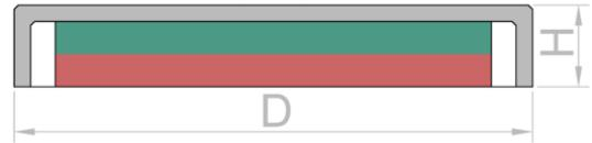
Fuerza transversal: la fuerza de sujeción indicada se midió en perpendicular a la base de adherencia. Para desplazar lateralmente el imán, se requiere una fuerza mucho menor. Así pues, si emplea un imán en recipiente en una pared, la carga que podrá aplicarle será mucho menor a la que se puede aplicar en el techo.
