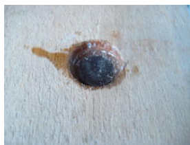
Scheibenmagnet, im Keil versenkt und mit Leim abgedichtet
